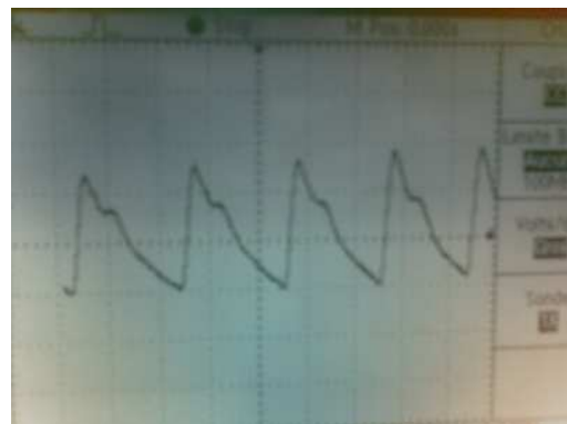
Photo 4.4 : Signal à la sortie du filtre AC.
