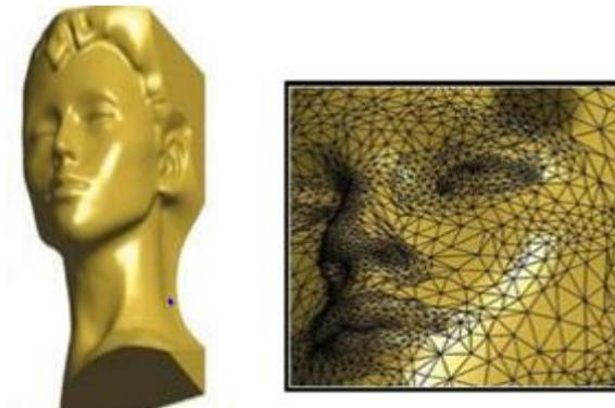
Figure I.4 : Modélisation surfacique avec plusieurs points.
