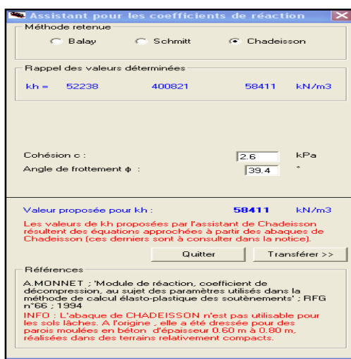
a)-Valeur calculée de coefficient de réaction b)-Valeur à lire sur l'abaque de chadeisson entre les droites (50000 et 60000KN/m3)
