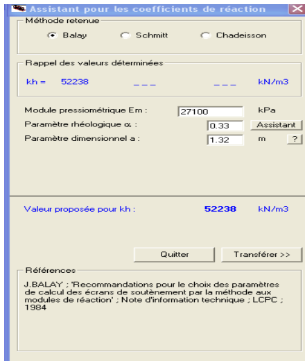
a)- Introduction des paramètres pour la méthode Balay
