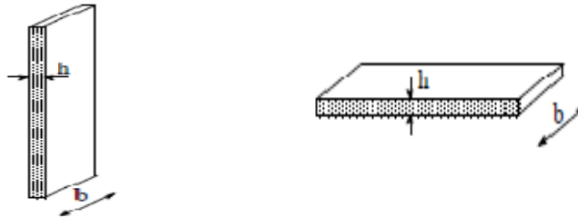
Figure 4.4- Dimensions des éléments poutre et dalle.
