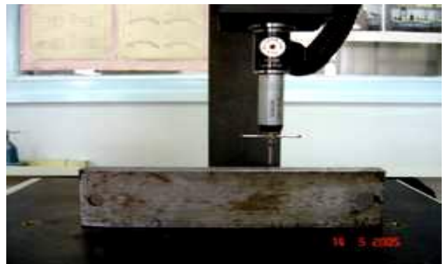
Fig.3.6. Contrôle de la rectitude de la glissière
