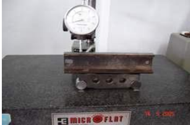
Fig.3.5. Contrôle de la rectitude de la glissière
