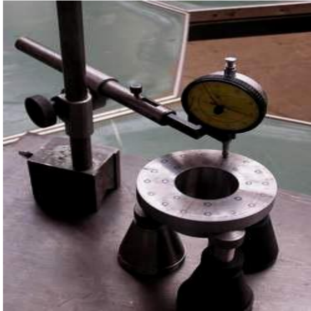
Fig.3.10b. Contrôle de la planéité du palier moteur sur marbre
