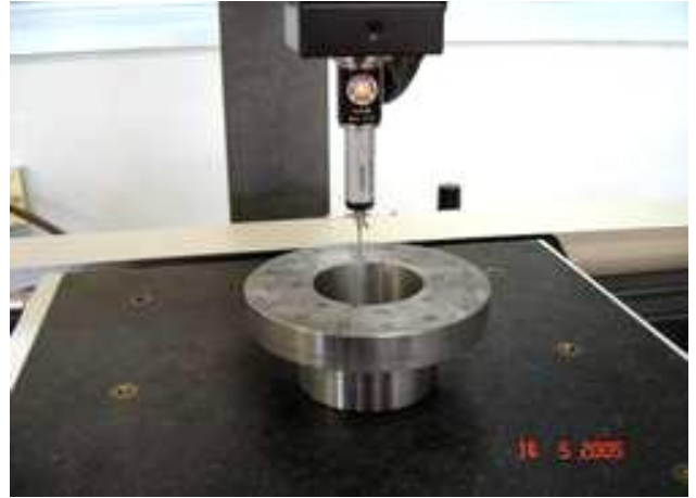
Fig.3.11. Contrôle de la planéité du palier sur MMT
