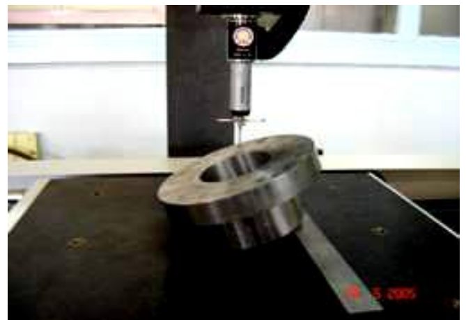
Fig.3.12 Contrôle de la planéité du palier sur MMT
