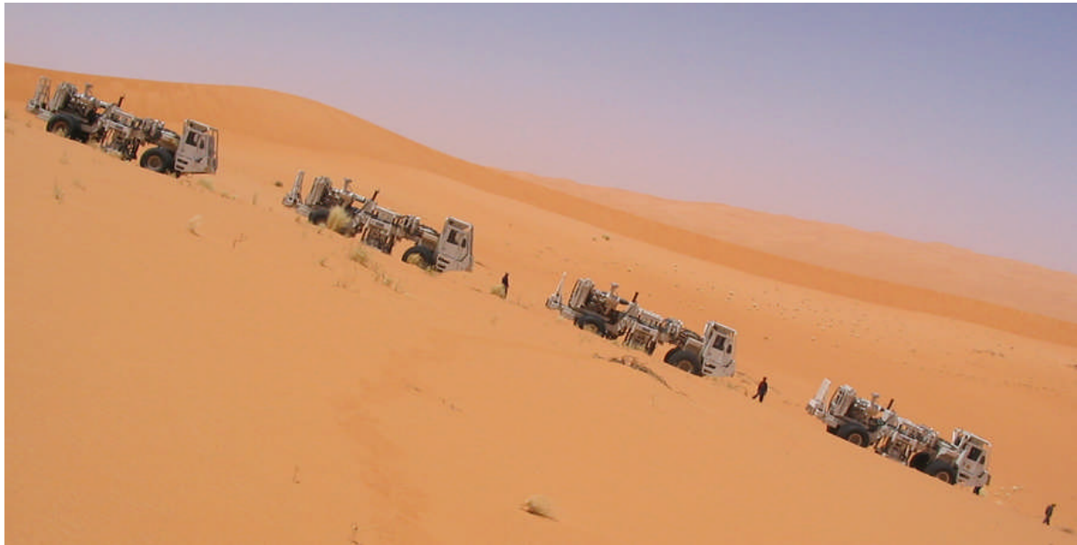
Figure 5.4. Positionnement des vibrateurs dans la ligne source.
