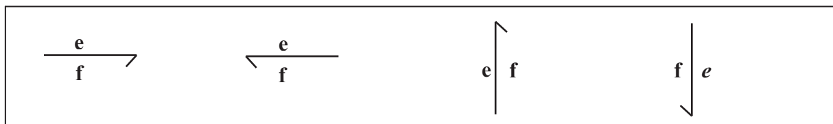
Figure I.1 : Le sens de transmission de la puissance.
