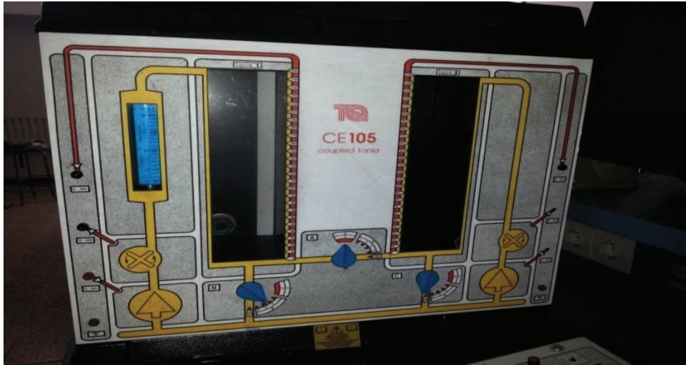
Figure IV.1 : Le système étudié « CE105 » (Banc de régulation ».
