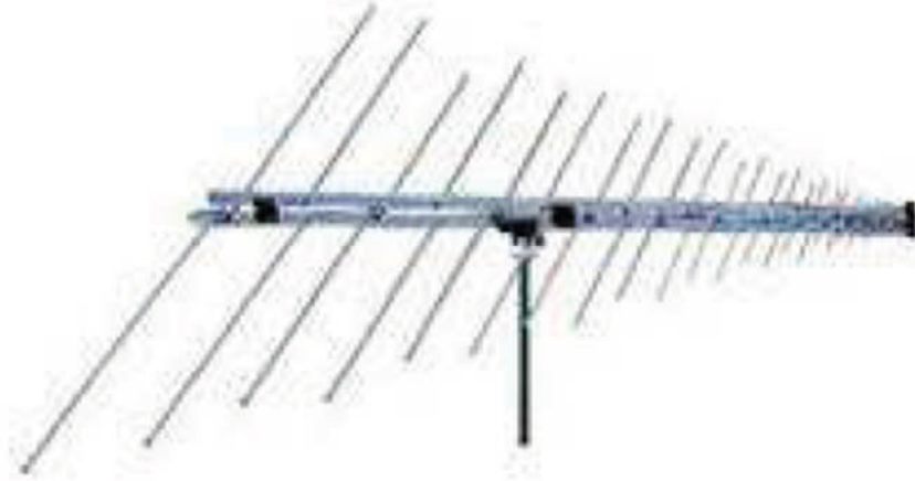
Figure II.6 : Réalisation de l'antenne dipôle log-périodique.
