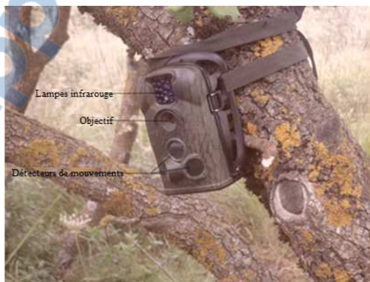
Photo 7 : Caméra piège modèle Ltl Acorn 5210A fixé sur un tronc d'arbre
