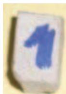
Figure 4.3 L'échantillon prismatique de (10x10x15) mm<sup>3</sup>
