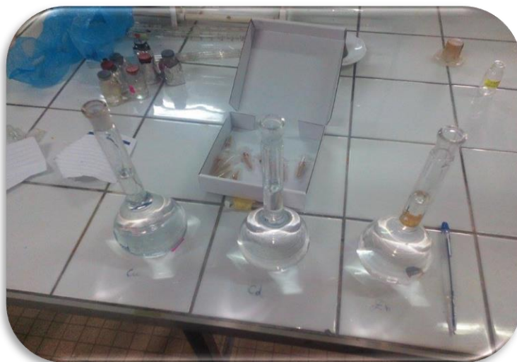
Figure 10 - préparation de différentes solutions métalliques avec les billes de chitosane. (Original).
