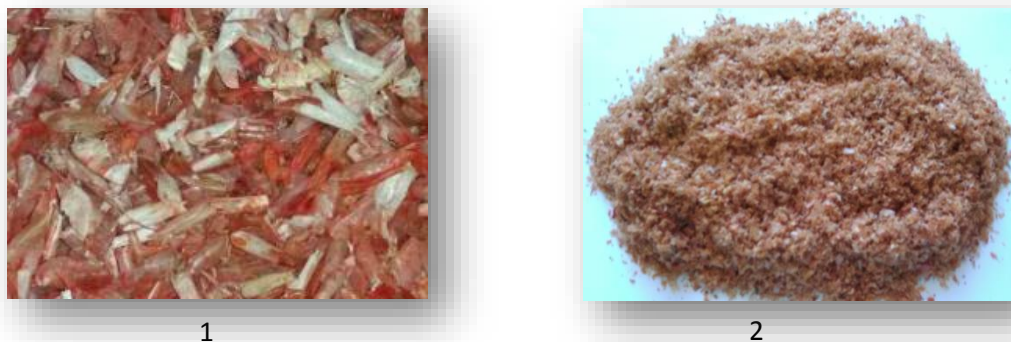
Figure 6 - (1) carapaces de crevettes lavés/séchés (2) carapaces des crevettes broyées, (original).
