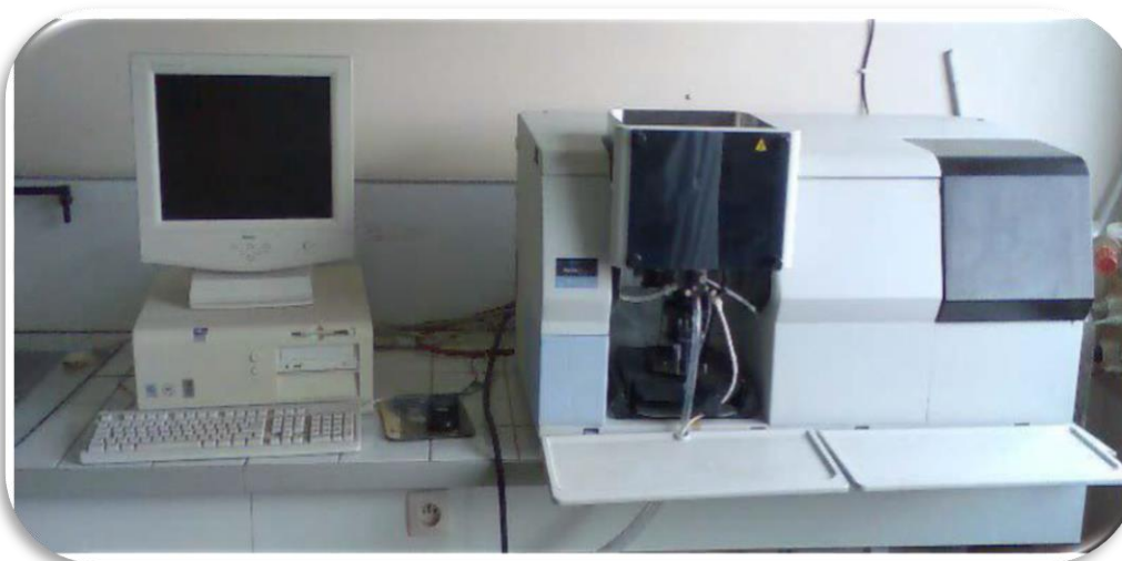
Figure 11 - photo d'un Spectrophotomètre d'absorption atomique PERKIN-ELMER A analyste 300.
