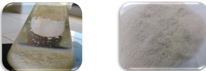
Figure 9 - Chitosane extrait qui sera solubilisé puis Billes/lentilles de chitosane produites (Original)
