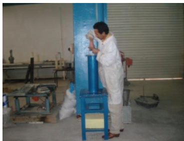
e) Mise en place de l'échantillon dans le cylindre
