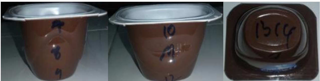
Figure 9 : Mesure de l'épaisseur des pots vides
