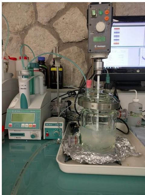
Figure 1 : dispositif expérimental pour l'expérience de dissolution des nano-ZnS
