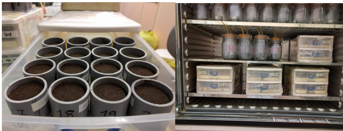
Figure 2 : microcosmes de sol et enceinte thermostatée
