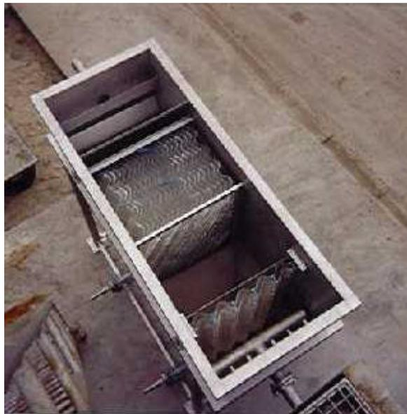
Figure 7 : Décanteur lamellaire (cliché Aaqua Waste Water Technology)
