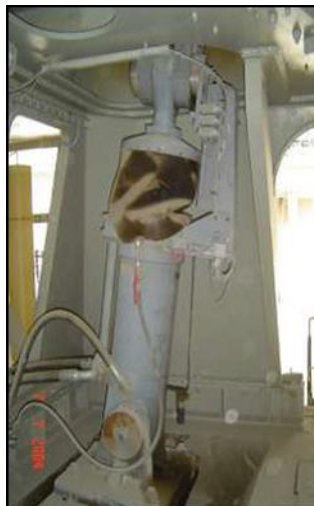
Figure 19: Vérin de travail et vérin fixe
