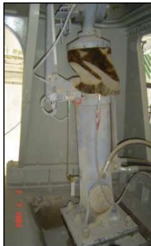
Figure 19: Vérin de travail et vérin fixe
