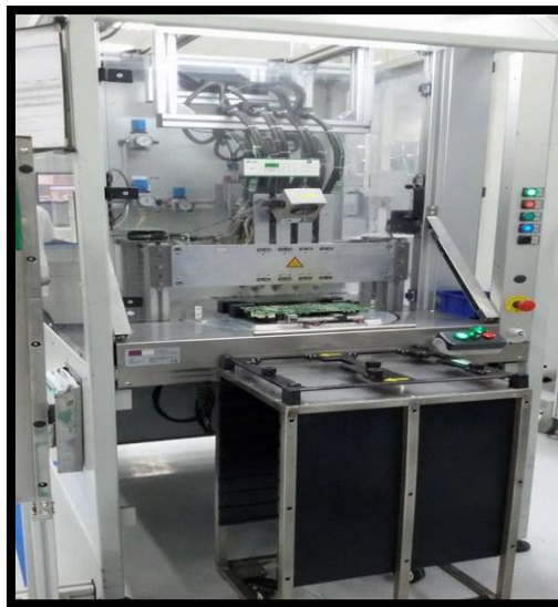
Figure 23: Machine "Bartec" pour la soudure des pins
