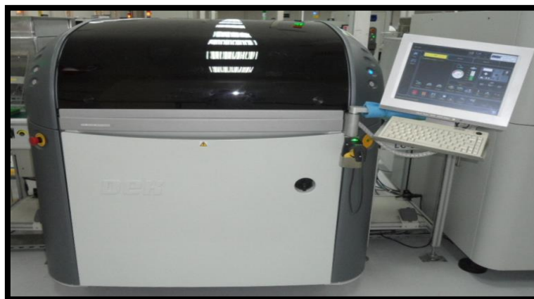
Figure 16: Machine « Dek » pour pose de la patte à braser
