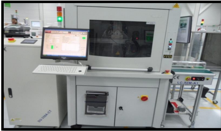
Figure 15: Machine "LAZPIUR" pour impression du N° de série
