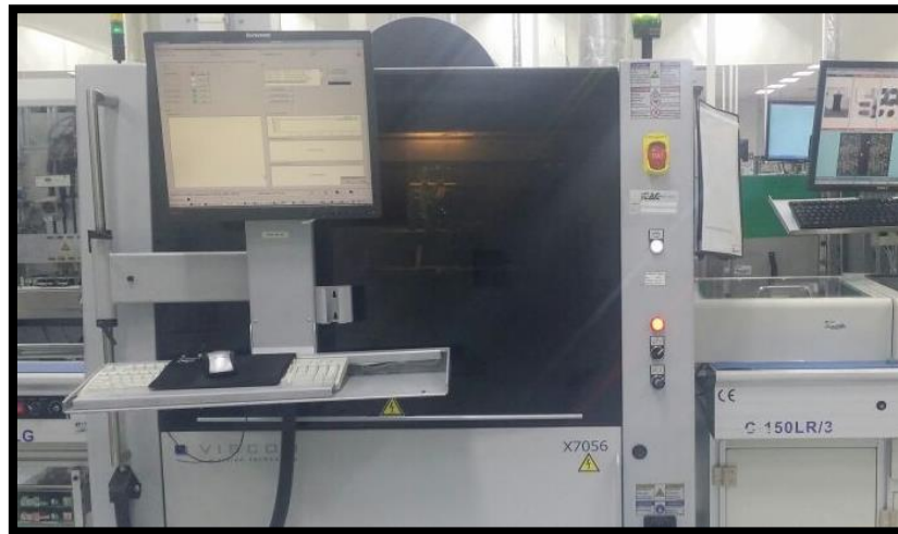
Figure 24: La machine "X-RAY" pour vérification de la soudure
