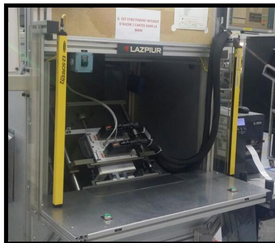
Figure 27: La machine "Lazpiur" effectuant le test fonctionnel
