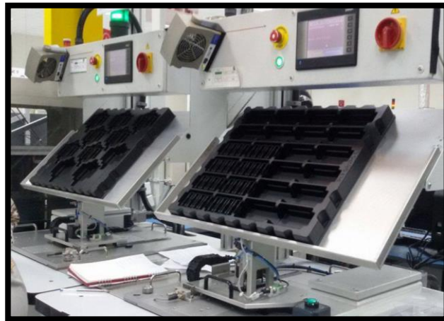
Figure 22: Poste pour pose des connecteurs
