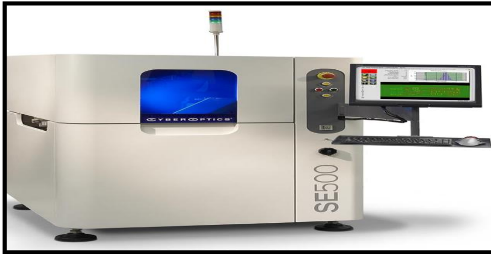
Figure 17: La machine "Cyber Optics" pour contrôler la patte à braser
