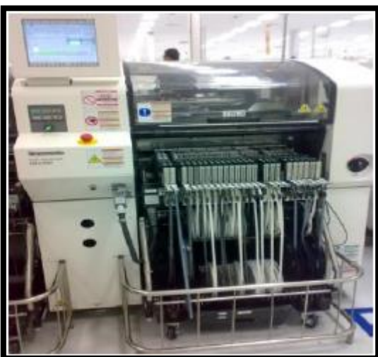
Figure 18: Machine « Panasonic » pour poser les composants
