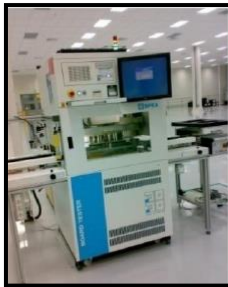
Figure 25: La machine "SPEA" pour le test ICT
