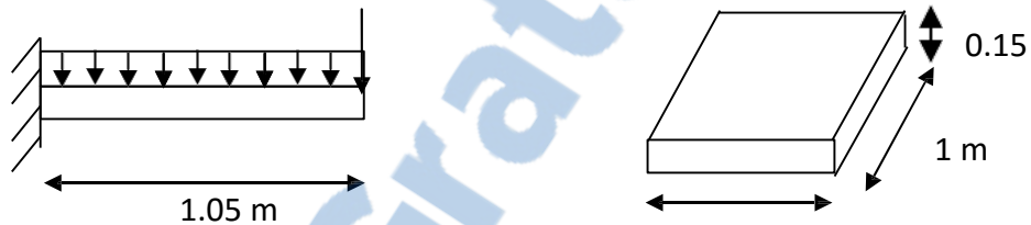
Figure 3.4 Schéma statique de la dalle pleine
