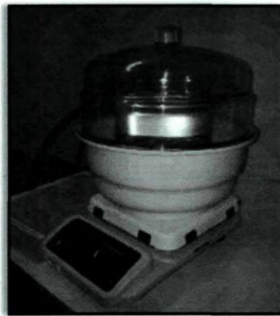
Figure 41: Équipement pour dégazage et déshumidification de l'huile.
