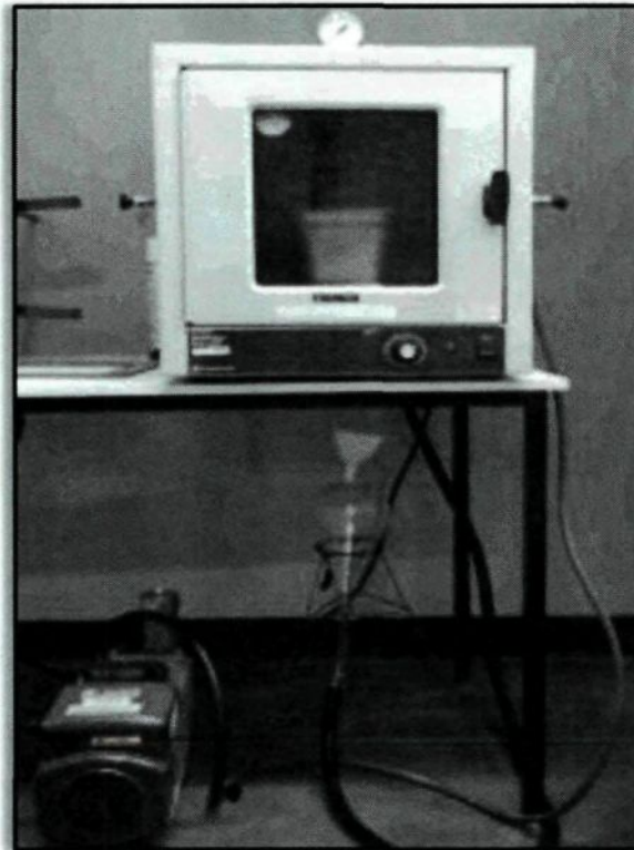
Figure 42: Four de séchage et d'imprégnation du papier.
