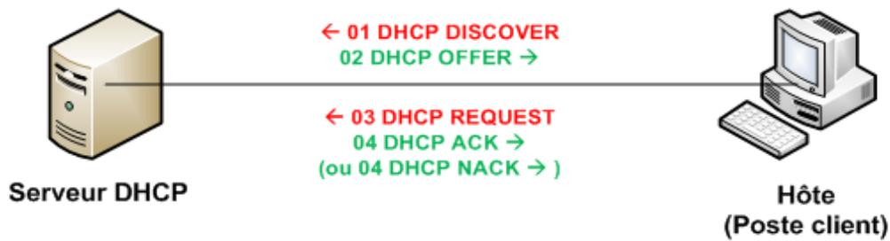
Figure 8: Principe de fonctionnement du DHCP
