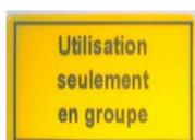
Etiquette utilisée pour les moyens de contrôle contenant plusieurs instruments de mesure. Les instruments sont vérifiés seulement dans leurs domaines d'utilisation. Les instruments ne sont pas identifiés avec les étiquettes vertes, seulement le moyen de contrôle est identifié
