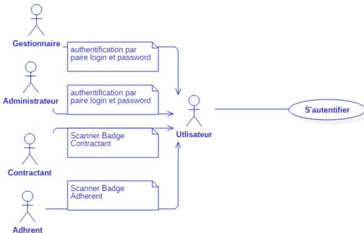
Figure 5:Diagramme de cas d'utilisation « Authentification »
