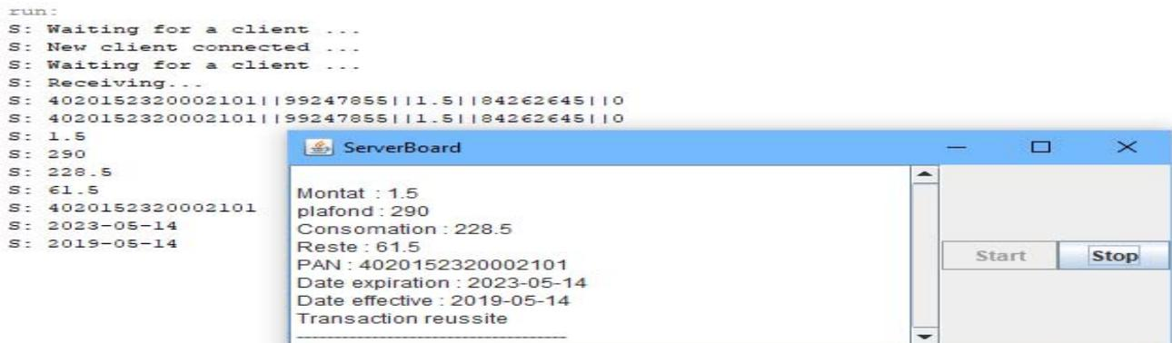
Figure 41: Serveur TCP Connexion Client et Réception Transaction
