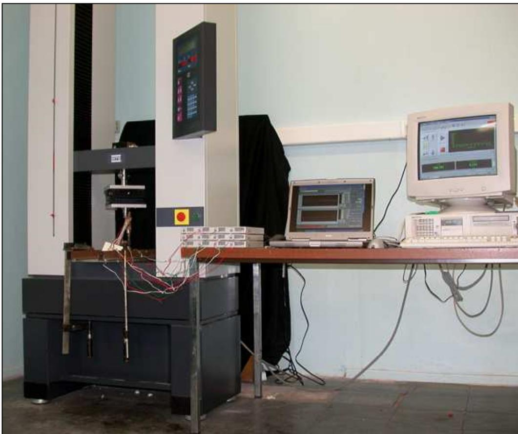
**Figure 37 : Photographie du dispositif expérimental complet**
