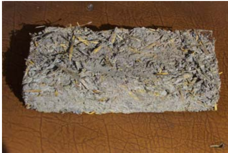
Figure 30 : Brique de béton léger en ciment-sable-paille (1/3,1/3,1/3) [14]
