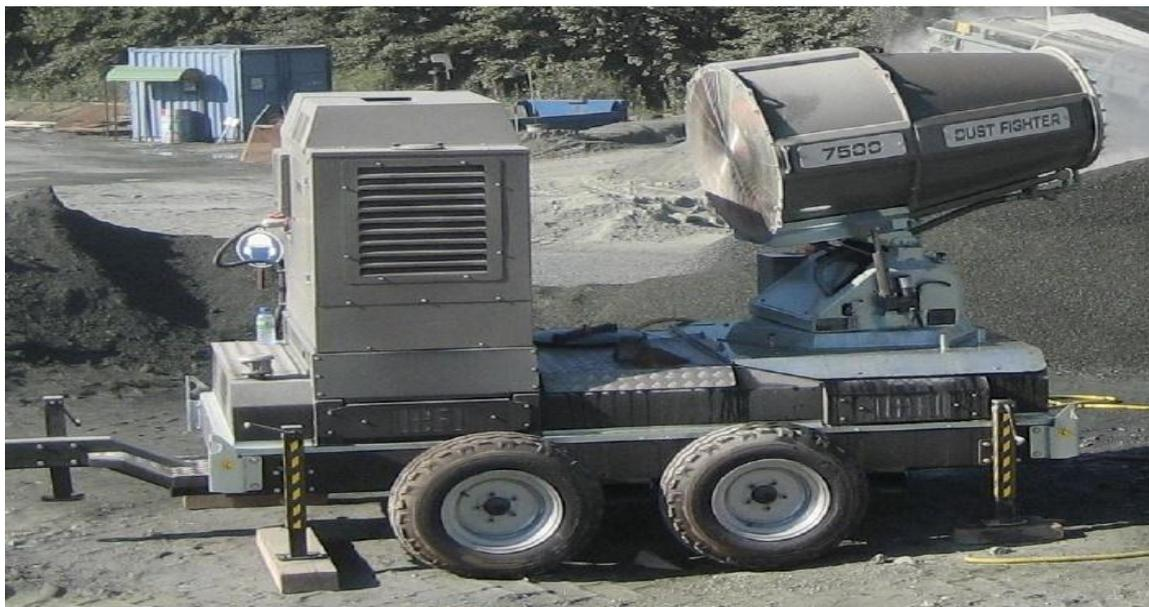
**Figure 20** : *DUST FIGHTER* avec groupe électrogène.
