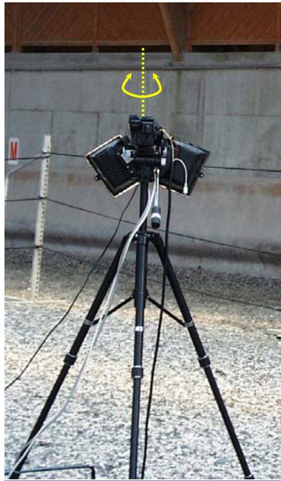
Le zoom des caméras est réglé pour filmer un champ de 6 à 7 mètres de long sur la piste du couloir d'obstacle. Le contraste de l'image est réglé manuellement afin d'obtenir une image foncée sur laquelle des marqueurs réfléchissants ressortent. La vitesse d'obturation des caméras est fixée à 1/1750 s.
