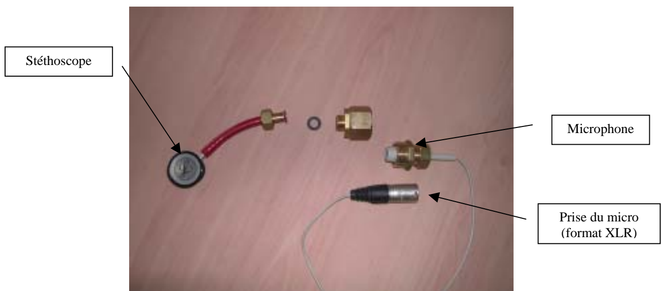
Figure 35 : Photo du montage de l'étude avec le microphone à la place des écouteurs
