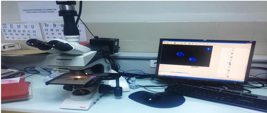
Figure 8 : Microscope binoculaire à épifluorescence adapté à la FISH et au caryotype.
