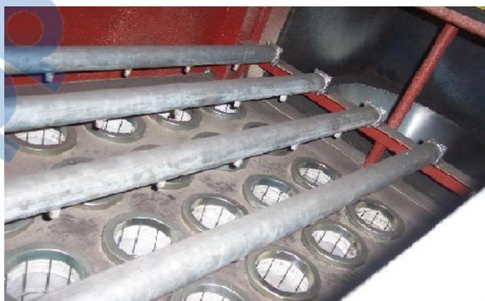
Figure 7 : compartiment air filtré.
