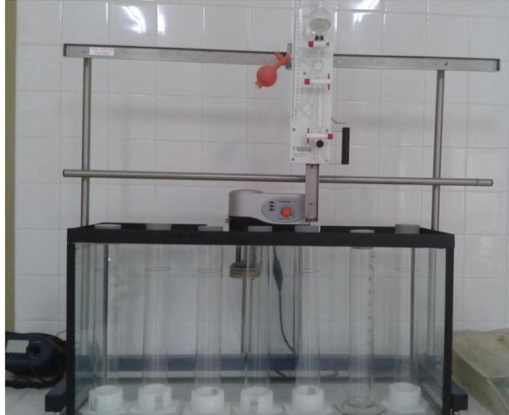
**Photo.1:** Appareil à pipette méthode Robinson
