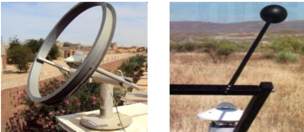
Figure I.4 : l'instrument qui mesure le rayonnement diffus [20]
