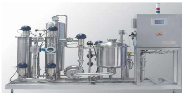
Fig. II.2 : Station de réception automatisé de type REDA
