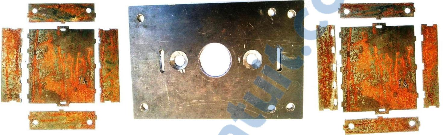
Figure 3.13 ENSEMBLE DES PIÈCES COMPOSANT LE BOÎTIER DU BROYEUR
