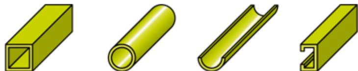
**Figure 2.18** TYPES DE PROFILE OBTENU PAR EXTRUSION
