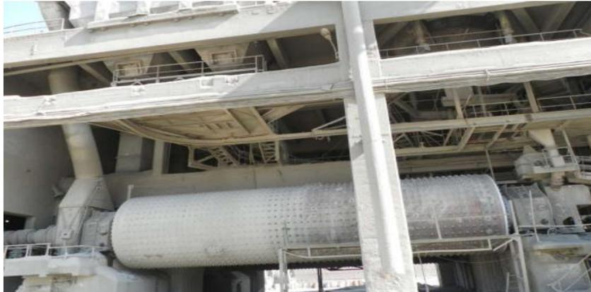
**Fig.III.17.** *Broyeur à ciment à la cimenterie de Béni Saf*
