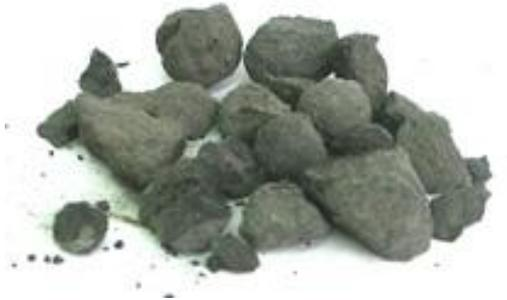
**Fig. I.4.** Granulés de clinker prêt à être broyé
