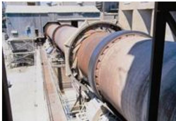
**Fig. I.3.** Four horizontal rotatif cylindrique en acier [13]
