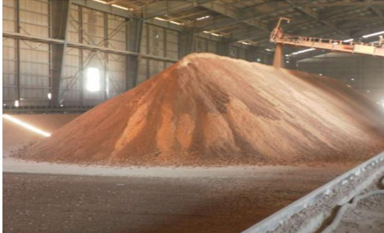
**Fig. III.7.** *hall de pré-homogénéisation*
