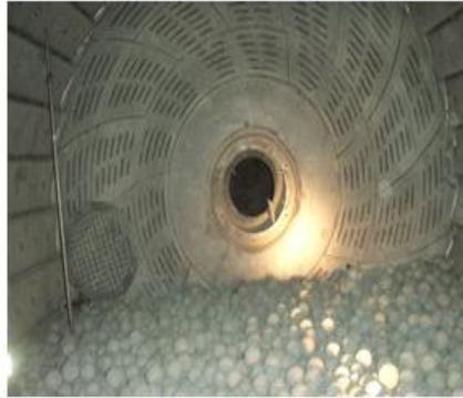
**Fig. I.5.** *Intérieur d'un broyeur à boulets* [5]
