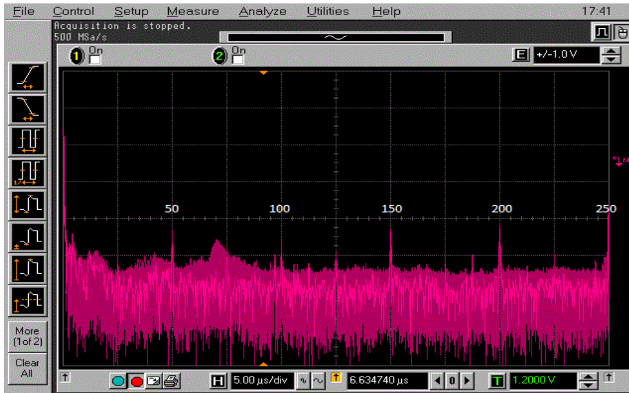
Figure 2.10 FFT de V_{DD} dans le mode fonctionnel sans commutation pour une fréquence de 50MHz
