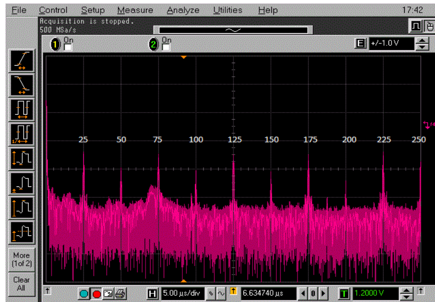
Figure 2.11 FFT de V_{DD} dans le mode fonctionnel avec commutation pour une fréquence de 50MHz
