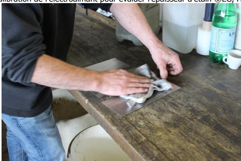
Figure 20 : Dégraissage des plaques ©EG, He-arc CR 2017
