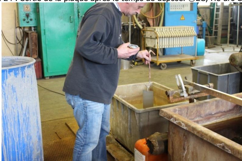
Figure 25 : Rinçage de la plaque. ©EG, He-arc CR 2017
