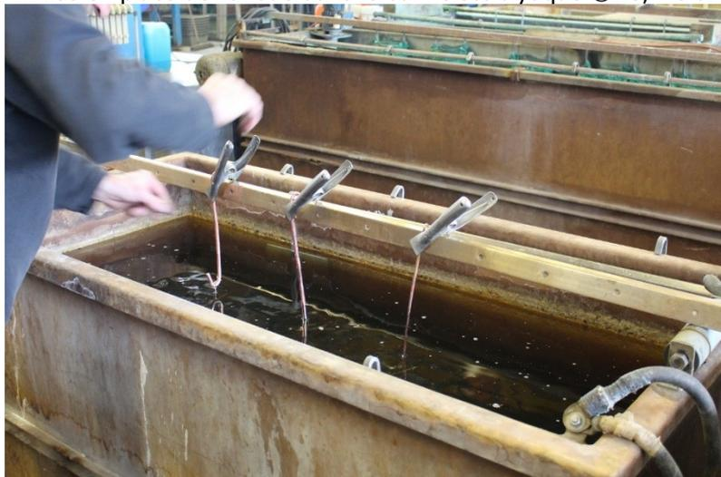
Figure 23 : Bain électrolytique ©EG, He-arc CR 2017
