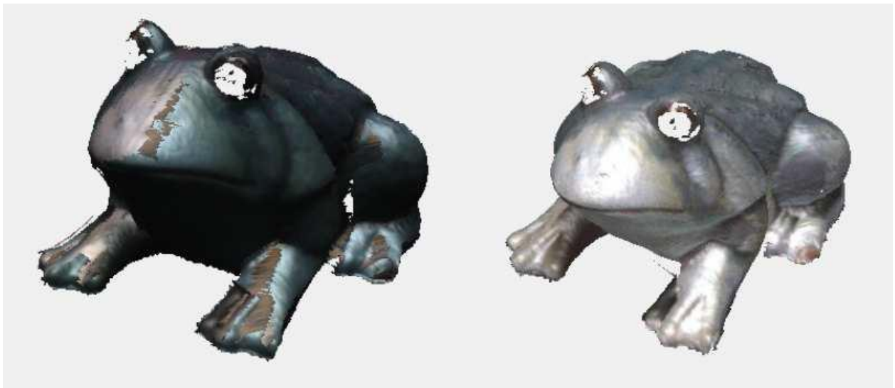
Figure 4.6 : Acquisition sans et avec contrôle de l'éclairage
