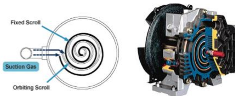
Figure 8 : l'architecture interne du compresseur d'Air à spirale.
