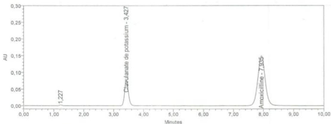
**Figure 18 : Chromatogramme de la solution témoin (b) des substances apparentées.**
