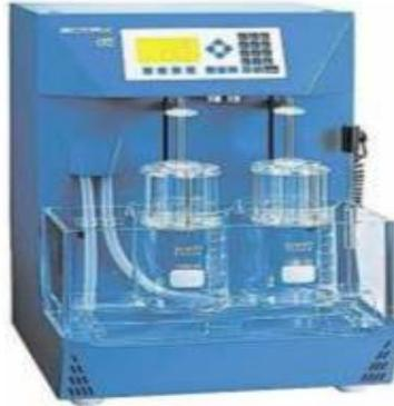
**Figure 12 : Appareil de désagrégation.**
