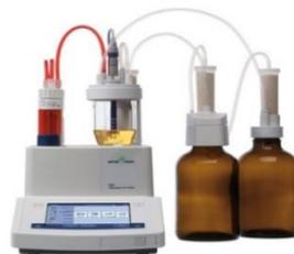
**Figure 11 : Appareil Titrateur volumétrique Karl Fischer METTLER TOLEDO DL 38.**
