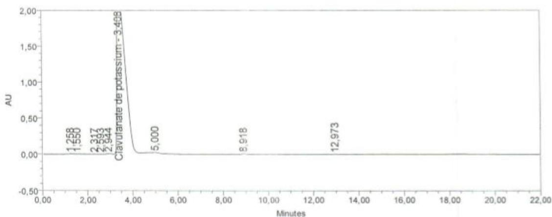
**Figure 20 : Chromatogramme de la solution essai des substances apparentées.**
