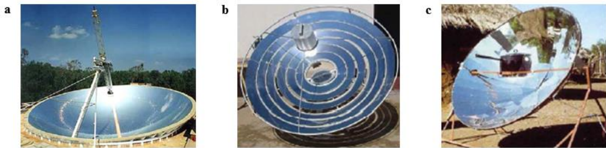
Figure II.10: Cuiseurs solaires concentrant la lumière par-dessous: (a) cuiseur sphérique; (b) cuiseur à miroirs de Fresnel; (c) cuiseur parabolique.
