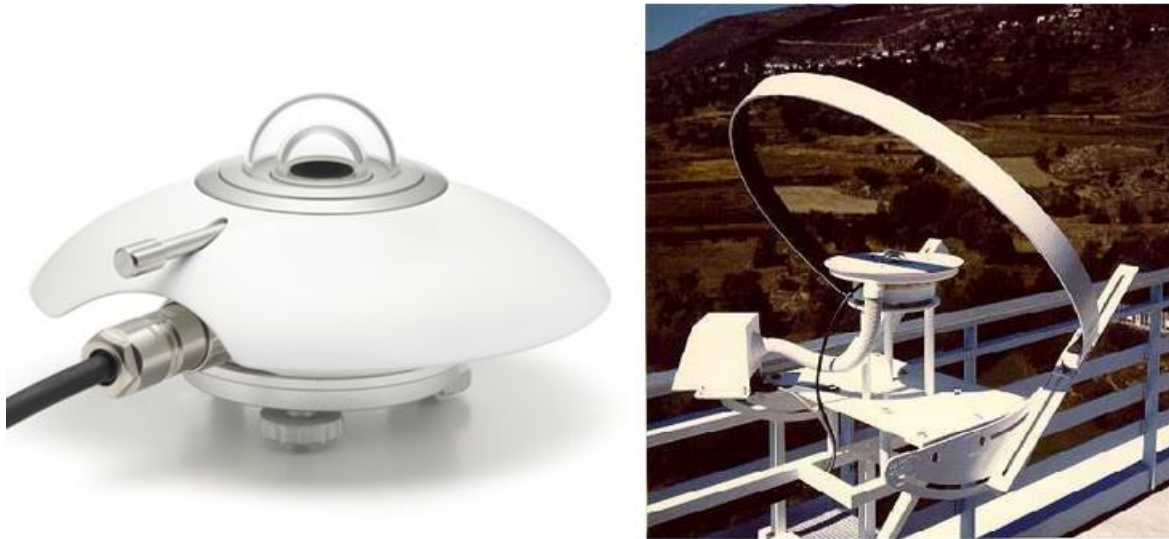
Figure III.5: Pyranomètre pour la mesure du rayonnement global et diffus
