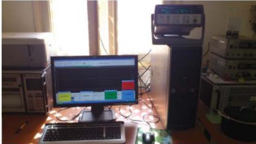
Figure III.10: Visualisation des températures sur un micro-ordinateur connecté à une unité d'acquisition de donnée
