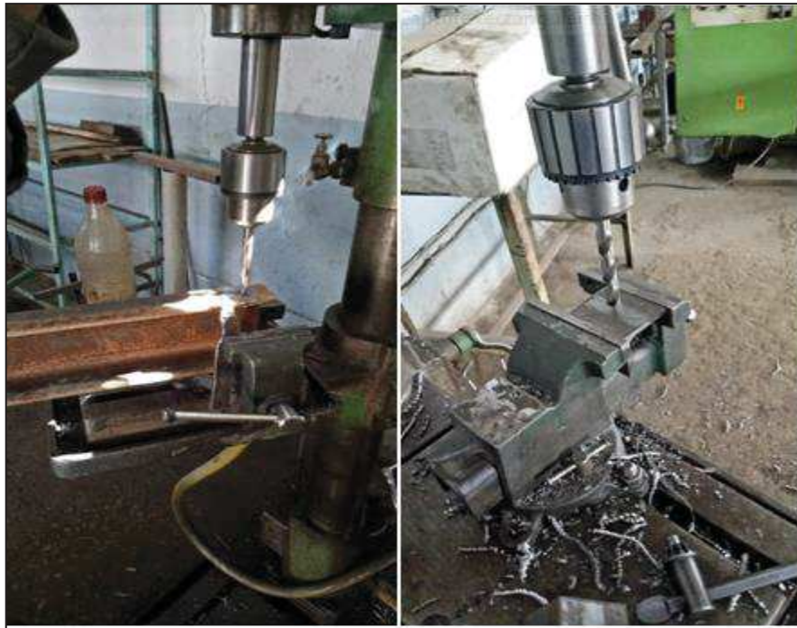
Fig.3.3. Perçage des poutrelles
