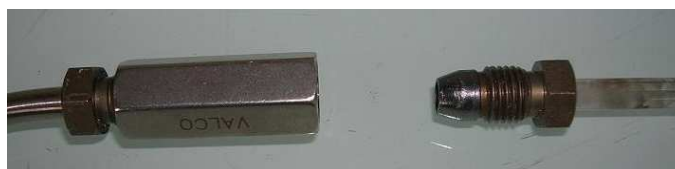
(b) Liaison quartz/inox par ferrule graphite et raccords Valco
