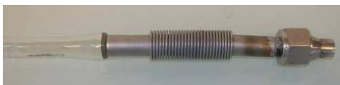
(a) Liaison quartz/inox par raccord Tombak
