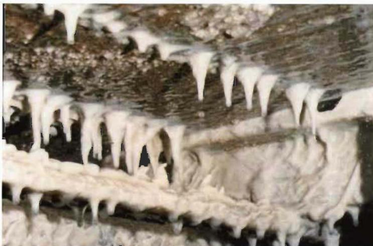
**Figure 1.3** Stalactites de biofilms sur la surface d'un tamis séparant l'eau de la pâte dans une papetière. Source : Flemming *et al.*, 2013.
