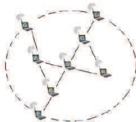
Figure II.6 : Zone de routage dans le protocole ZRP
