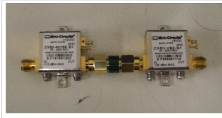
Figure 4.21 Photos des deux amplificateurs Mini-circuits cascades
