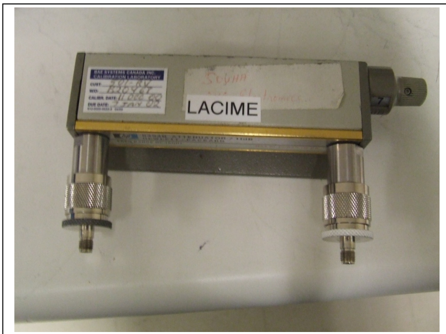
Figure 4.18 Photo de l'atténuateur HP8494B
