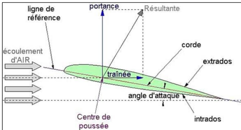
Figure 1.5 Représentation des forces de portance et de trainée sur un profil d'aile
