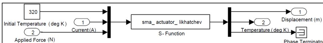
Figure 1.9 Aperçu de la modélisation numérique des actionneurs à mémoire de forme (SMA) utilisée sous Simulink
