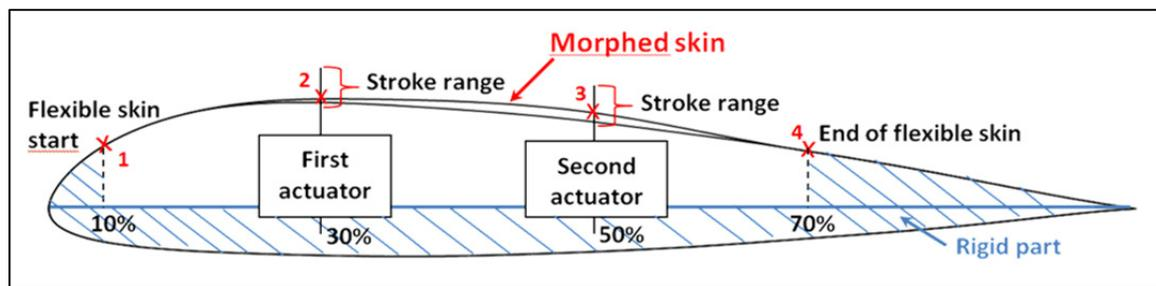
Figure 2.15 Schéma de la structure interne du profil d'aile. Localisation de l'emplacement des lignes d'actionnement et de la peau flexible en composite entre 10% et 70% de la corde
