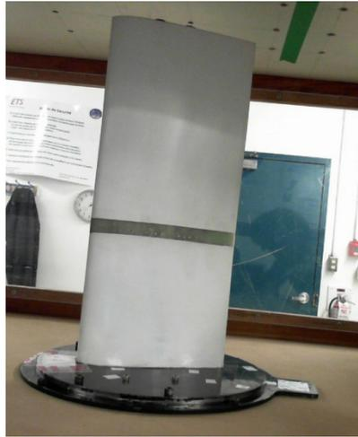
Figure 4.28 Photo de la maquette dans la soufflerie
