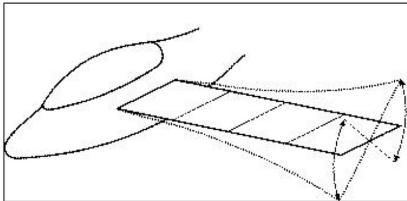
Figure 2.26 Schéma de la flexion que peut subir en vol l'envergure d'une aile d'avion
