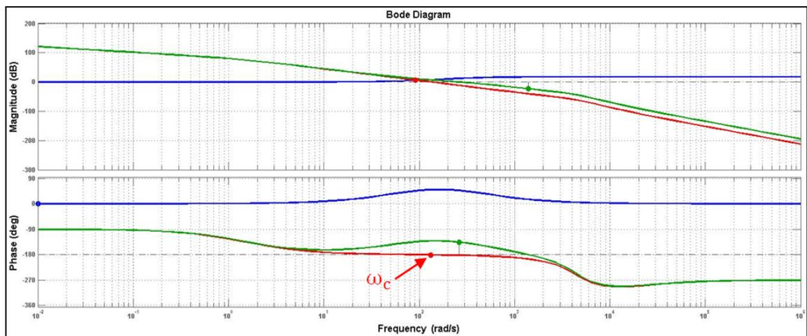
Figure 3.29 Diagrammes de Bode de l'ADP (en bleu), du processus en boucle ouverte (en rouge) et de la chaîne de régulation de position en boucle ouverte  $G_{ppb0}$  (en vert). La stabilité du processus est désormais assurée par le correcteur ADP
