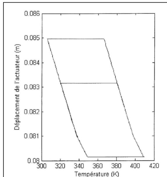
Figure 1.15 Évolution de la température en fonction du déplacement de l'actionneur SMA pour la méthode ZN
