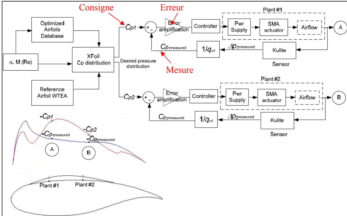
Figure 1.11 Schéma de la boucle fermée de commande des coefficients de pressions présents à la surface de l'aile
