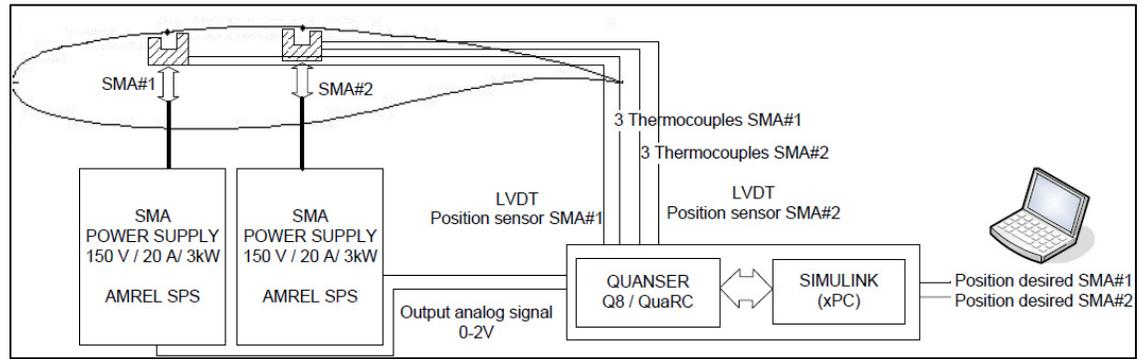
Figure 1.16 Architecture du banc de test de commande des actionneurs SMA
