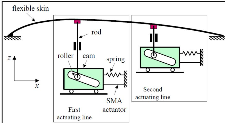
Figure 1.8 Schéma du principe mécanique réalisant la déformation de l'aile flexible
