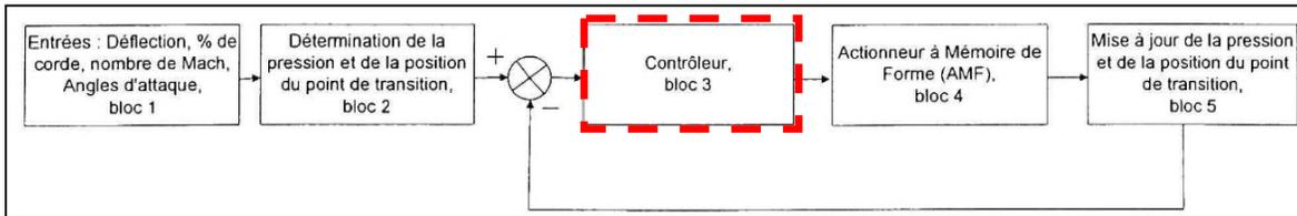
Figure 1.13 Schéma de la boucle fermée du régulateur de la position du point de transition
