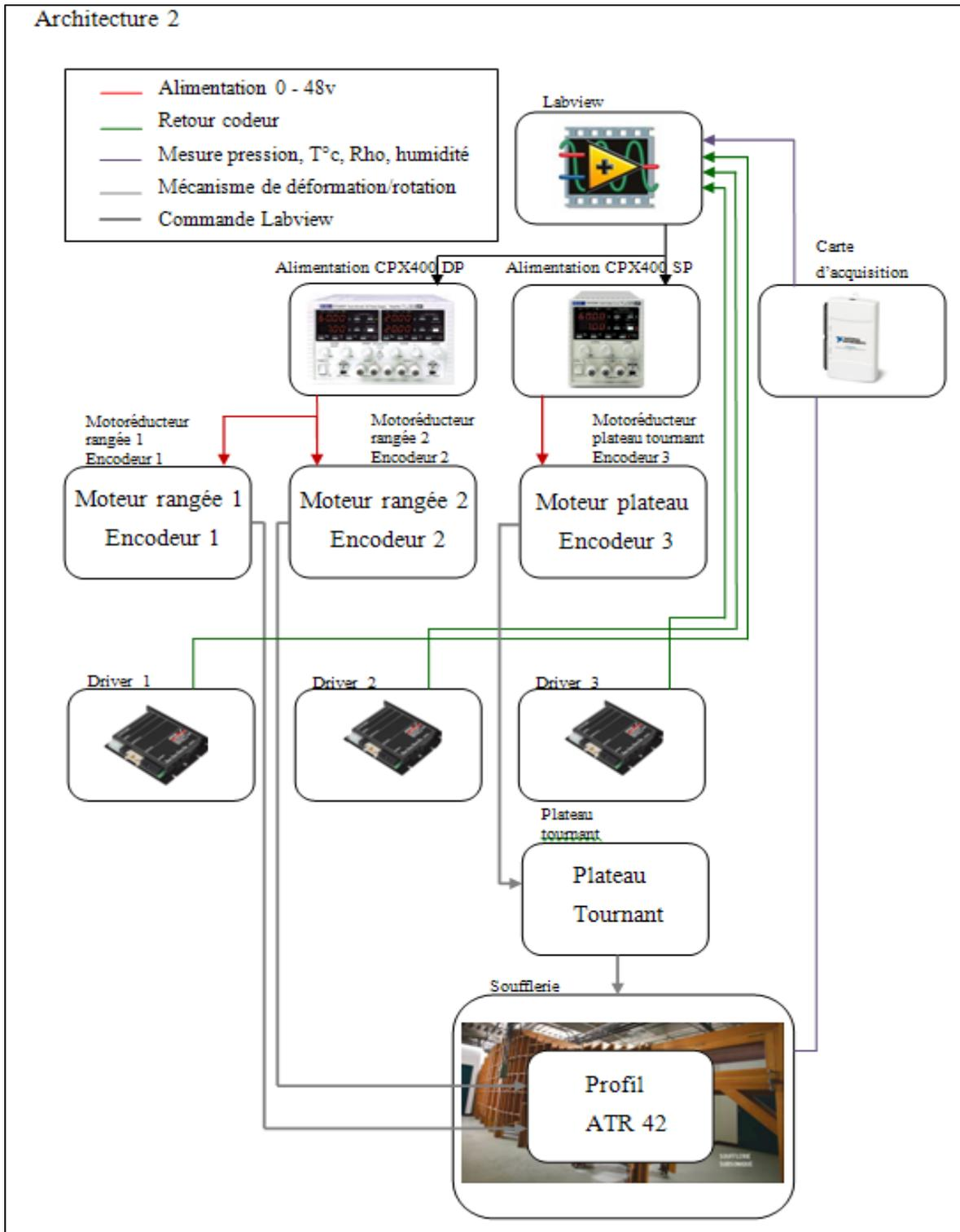
Figure 2.25 Architecture avec les régulateurs dimensionnés avec LABview
