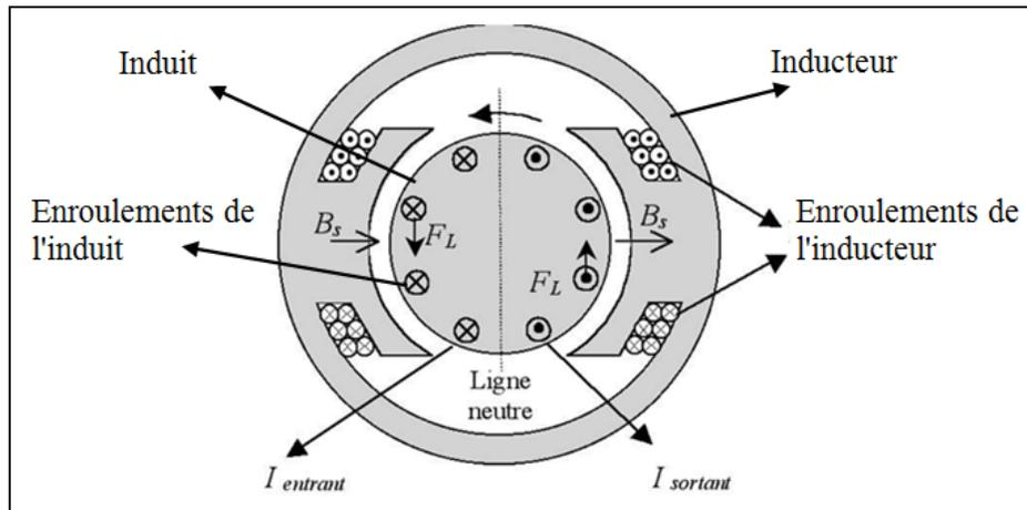
Figure 3.1 Schéma de la constitution mécanique d'une MCC composé de l'inducteur, de l'induit et des enroulements
