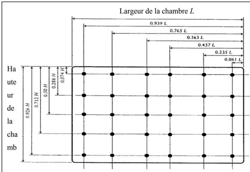
Figure 2.2 Coordonnées des points dans un plan pour mesurer les vitesses lors de la calibration de la soufflerie
