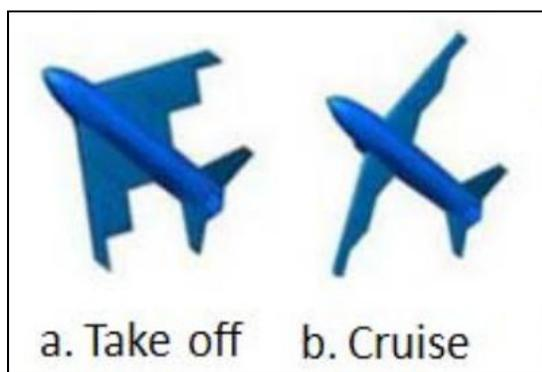
Figure 1.1 Formes idéales des ailes d'avions pour les différentes phases de vol
