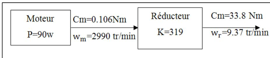
Figure 2.21 Schéma bloc du moteur et du réducteur
