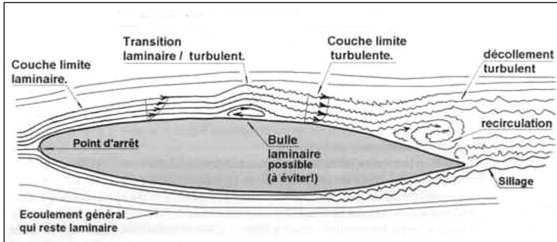
Figure 1.6 Représentation des différents régimes d'écoulement de l'air autour d'une aile d'avion
