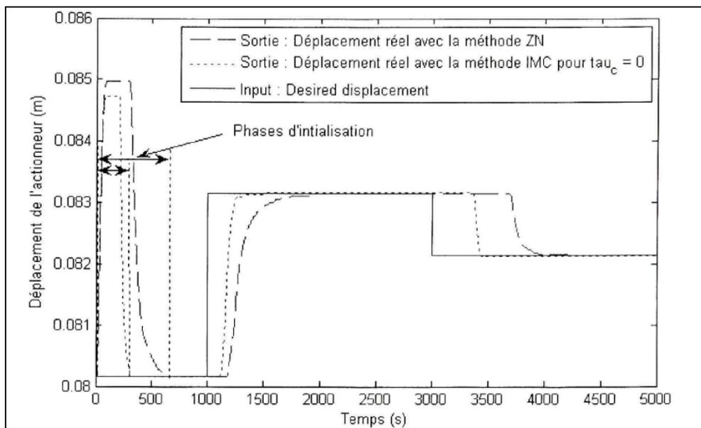
Figure 1.14 Comparaison des réponses en déplacements de l'actionneur à mémoire de forme en fonction du temps pour les méthodes Ziegler et Nichols et de Contrôle du Modèle Interne
