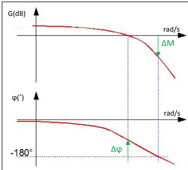
Figure 3.5 Diagramme de Bode représentant les marges de phase et de module de la Fonction de Transfert en Boucle Ouverte (FTBO), pour l'étude de la stabilité d'une boucle de régulation
