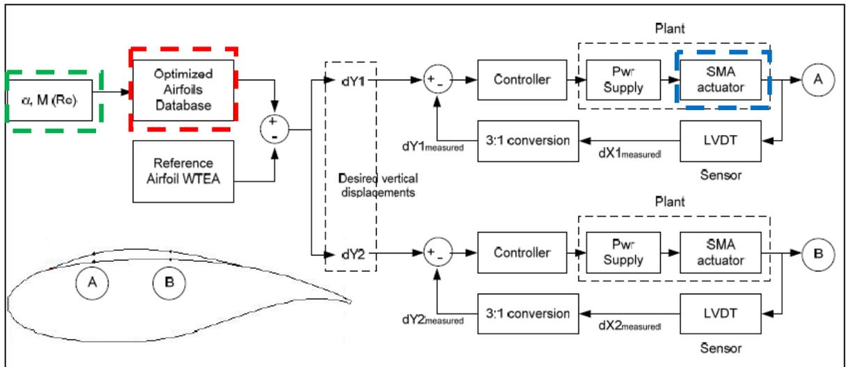
Figure 1.10 Schéma de la boucle ouverte de commande de la position des actionneurs SMAs
