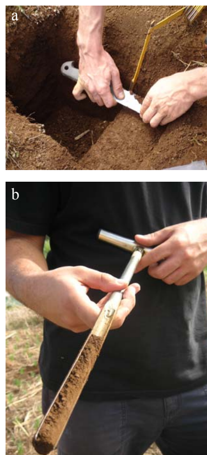
Figure 3 : photographies des échantillonnages : a) prélèvement au couteau dans une fosse, b) prélèvement à la gouge en surface
