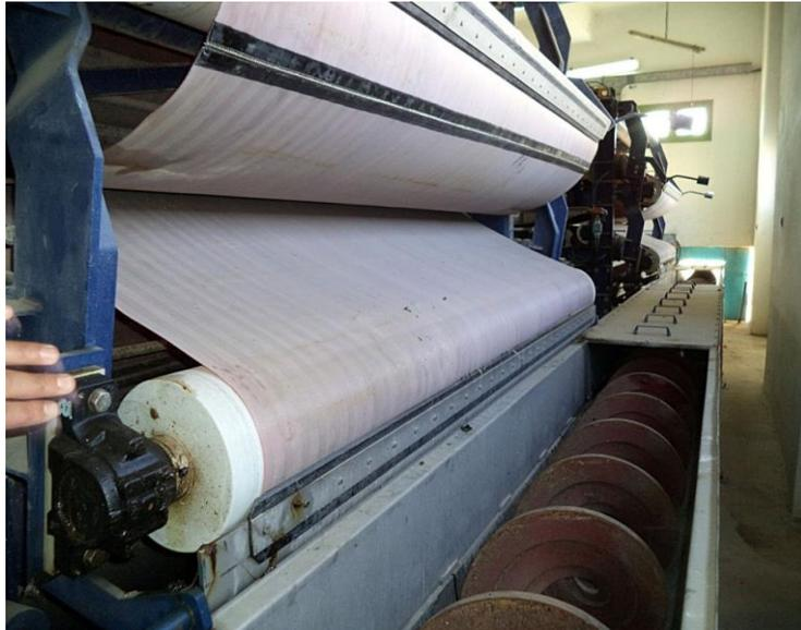
**Figure III.15 :** Photo du filtre à bandes
