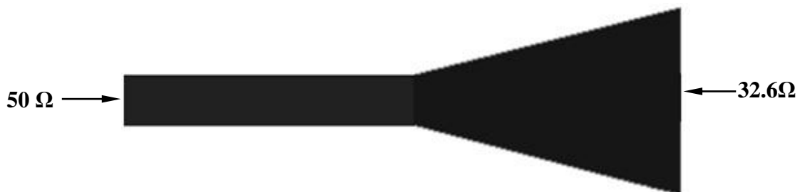
Figure I.18. Schéma de la ligne de transition vers un guide GIS sous ADS®.
