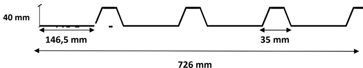
**Fig.III.4** Tôle nervurée
