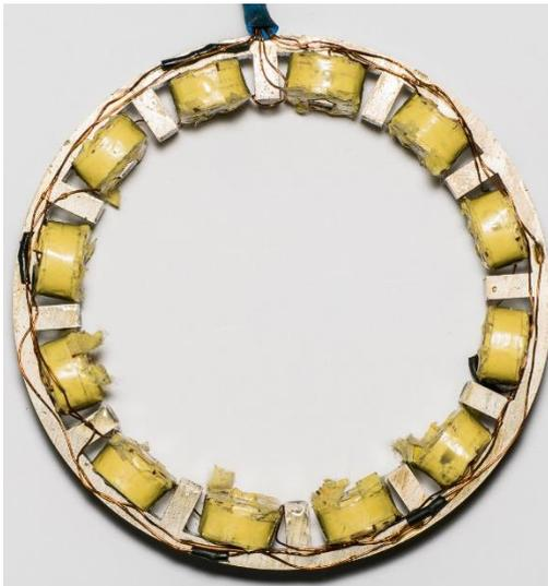
Photo 6: stator vue de face
